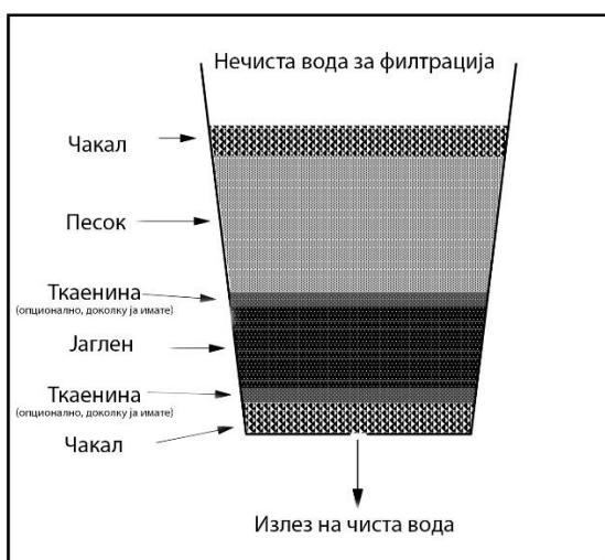
Слика 1: Пресек на филтер (Чакал - Песок - Ткаенина - Јаглен - Ткаенина - Чакал)
